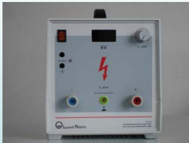
แหล่งจ่ายไฟฟ้าแรงดันสูง
