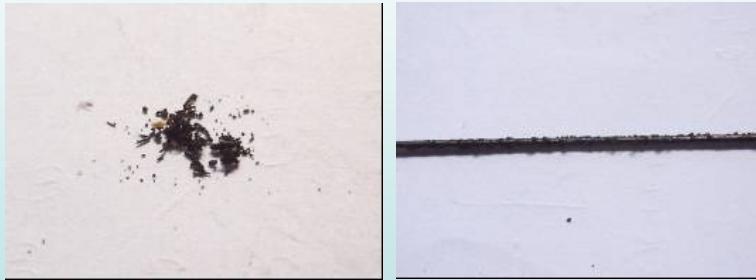
อนุภาคจากการเผาไหม้สะสมตัวบนขั้วดิสชาร์จ์
